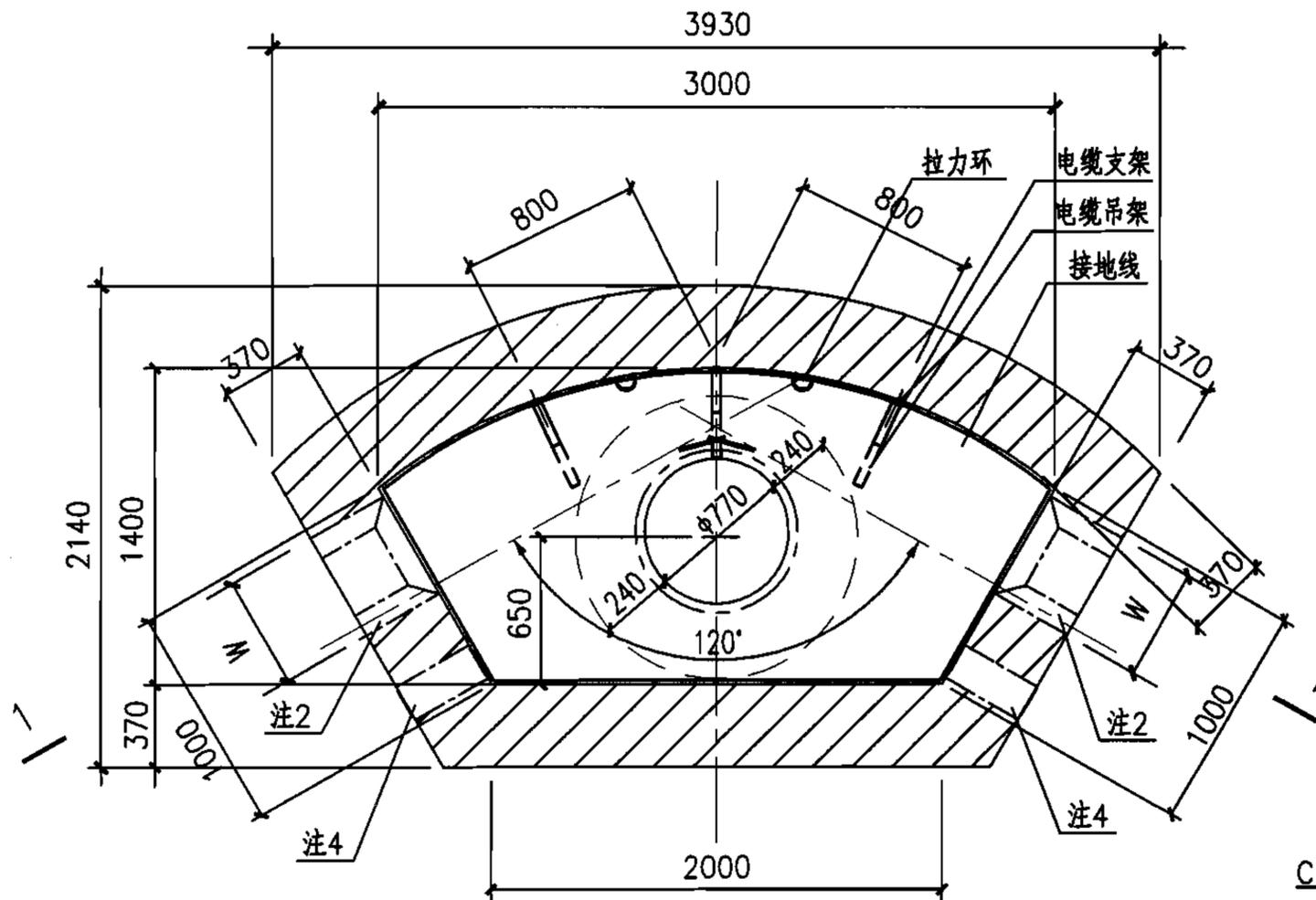
中型120°转角型电缆井平面图
