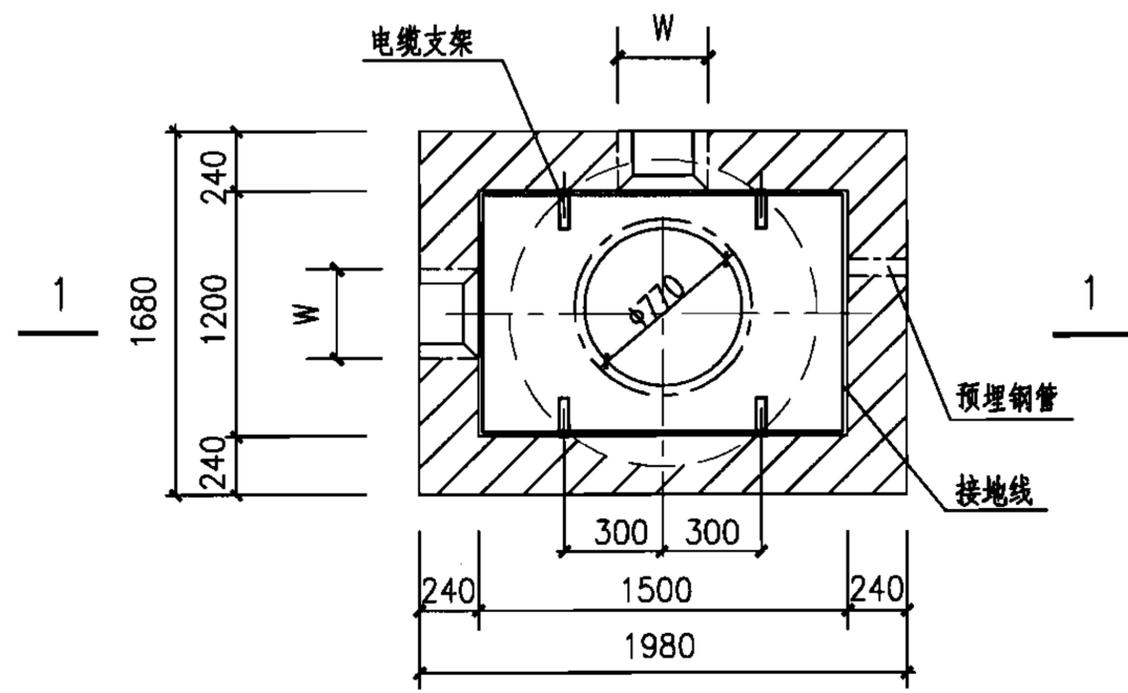
中型电缆手孔井平面图
