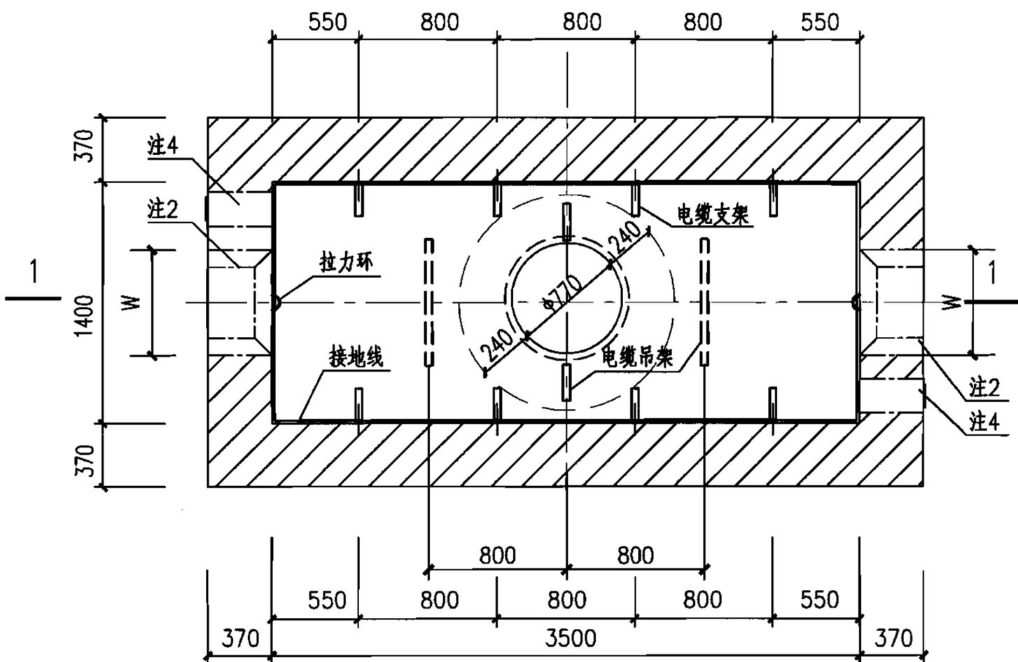
大型(二)直通型电缆井平面图
