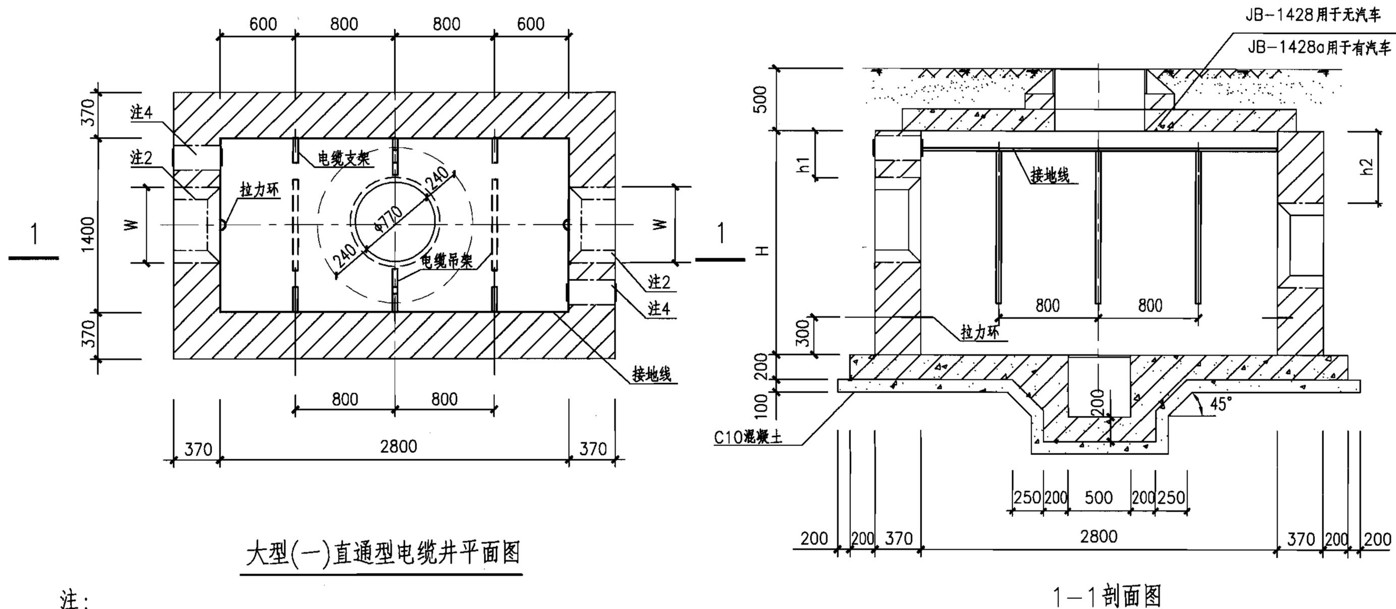
大型(一)直通型电缆井平面图
