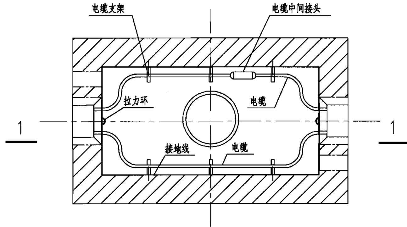
电缆在电缆井中中接头平面图
