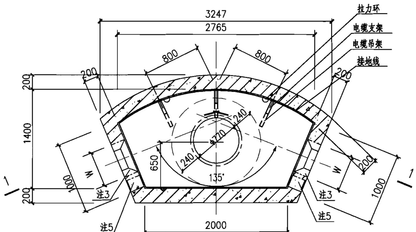
中型135°转角型电缆井平面图
