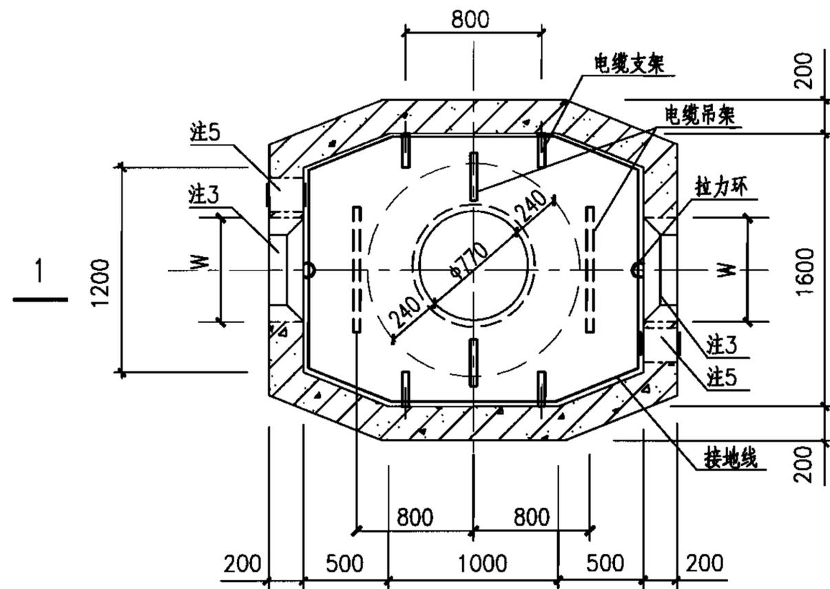
小型直通型电缆井平面图
