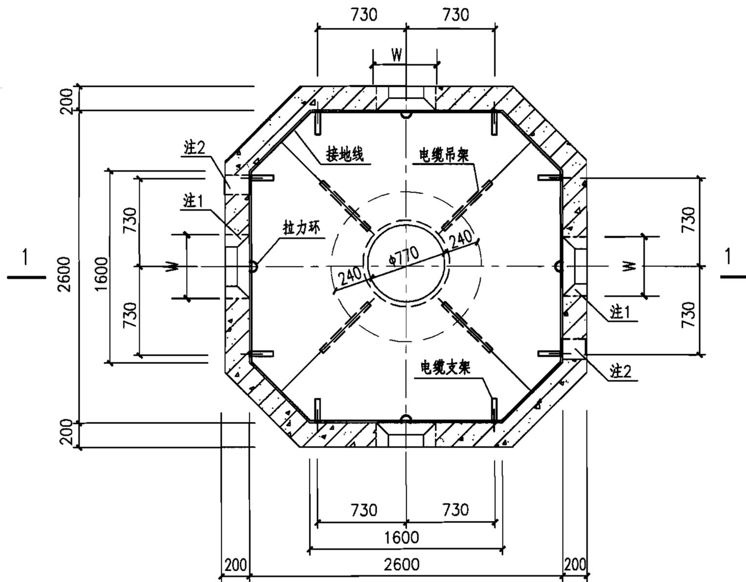
大型(一)四通型电缆井平面图
