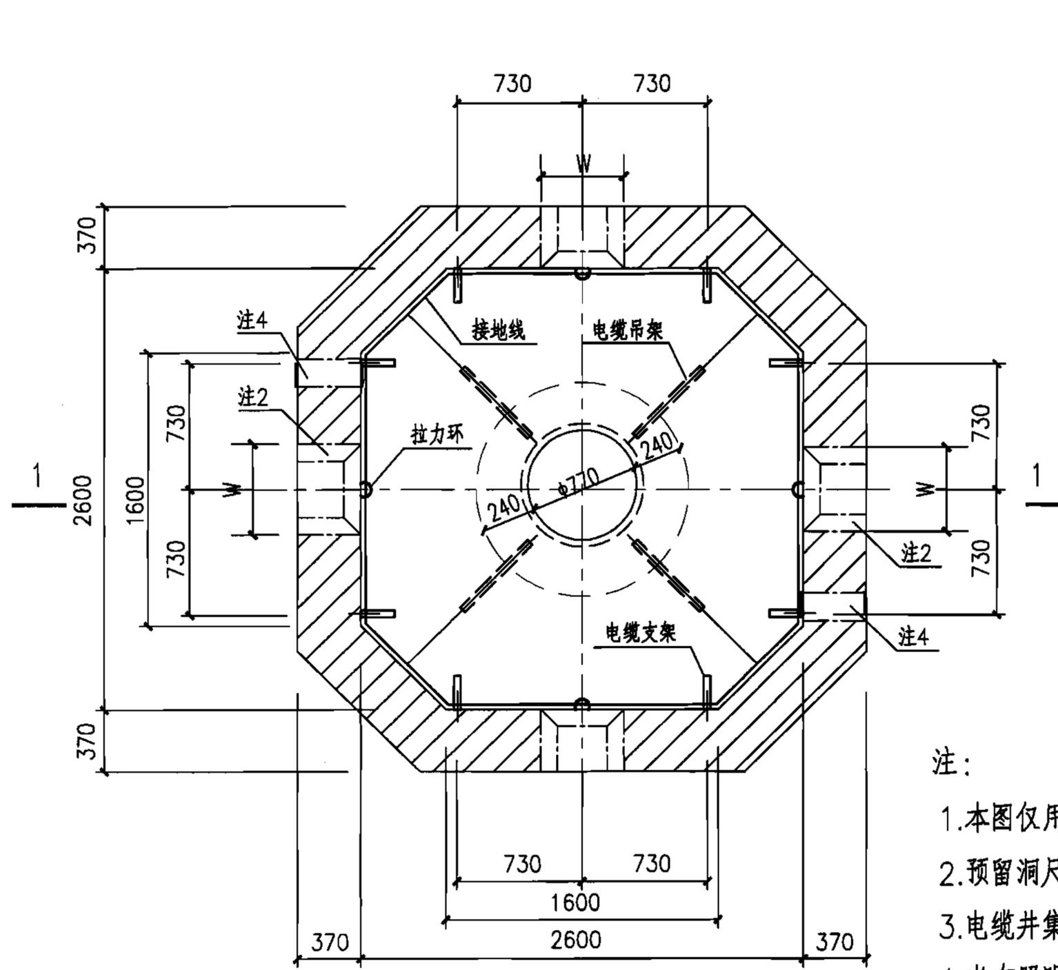
大型(一)四通型电缆井平面图
