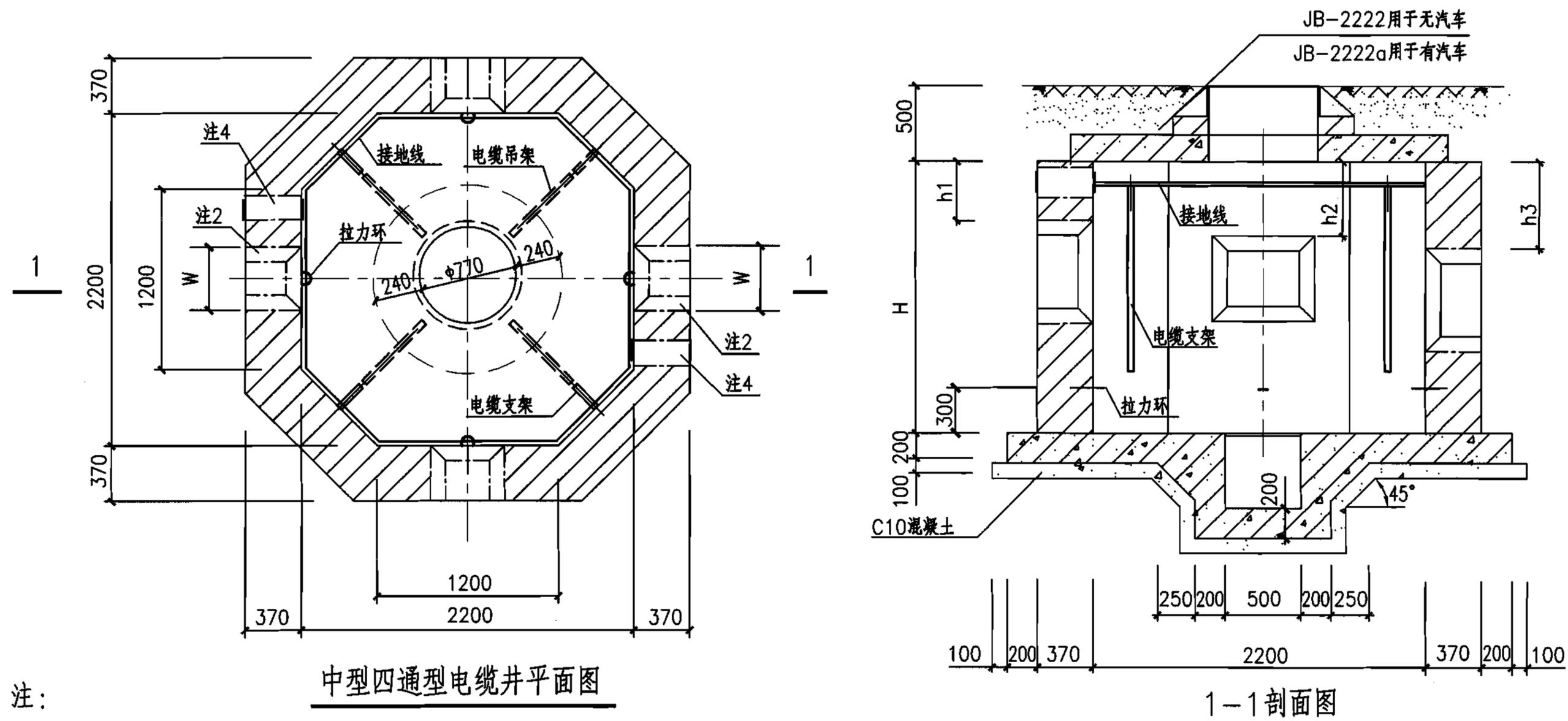
中型四通型电缆井平面图
