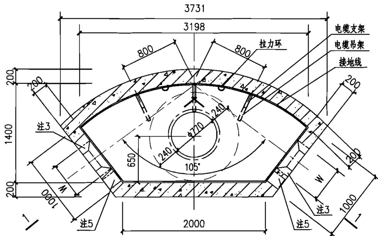
中型105°转角型电缆井平面图
