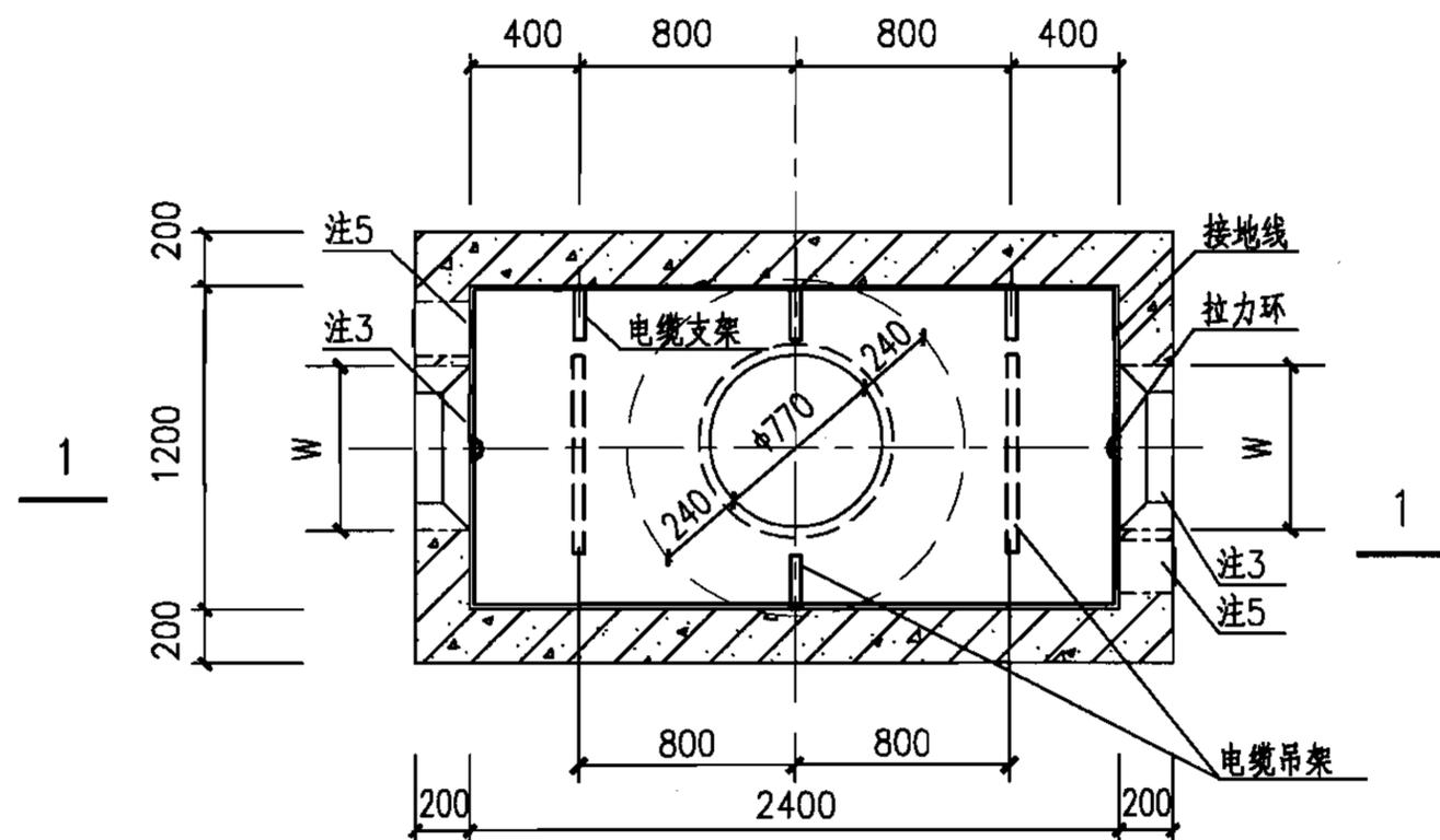
中型直通型电缆井平面图
