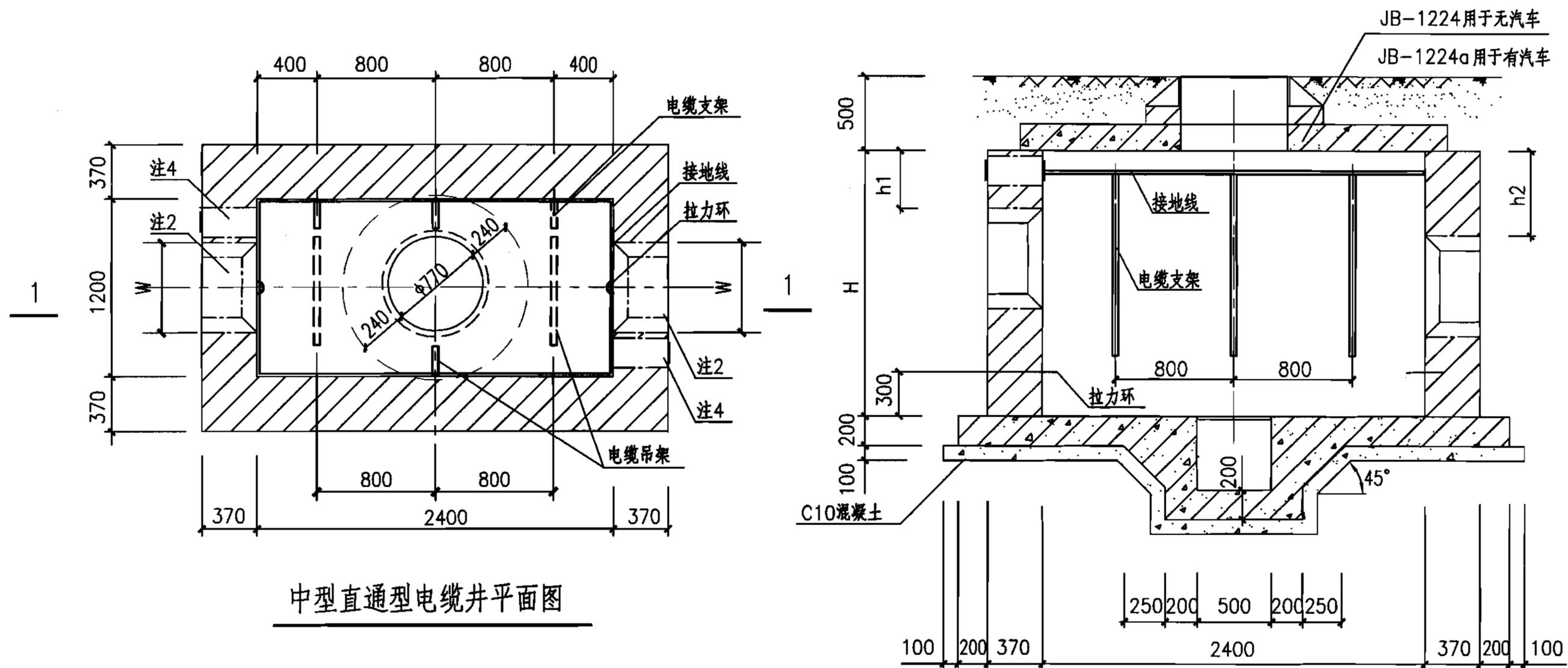
中型直通型电缆井平面图
