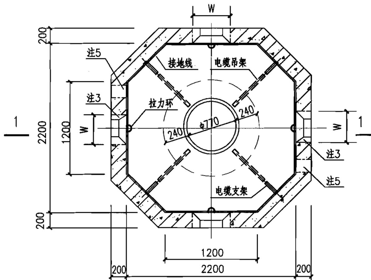
中型四通型电缆井平面图
