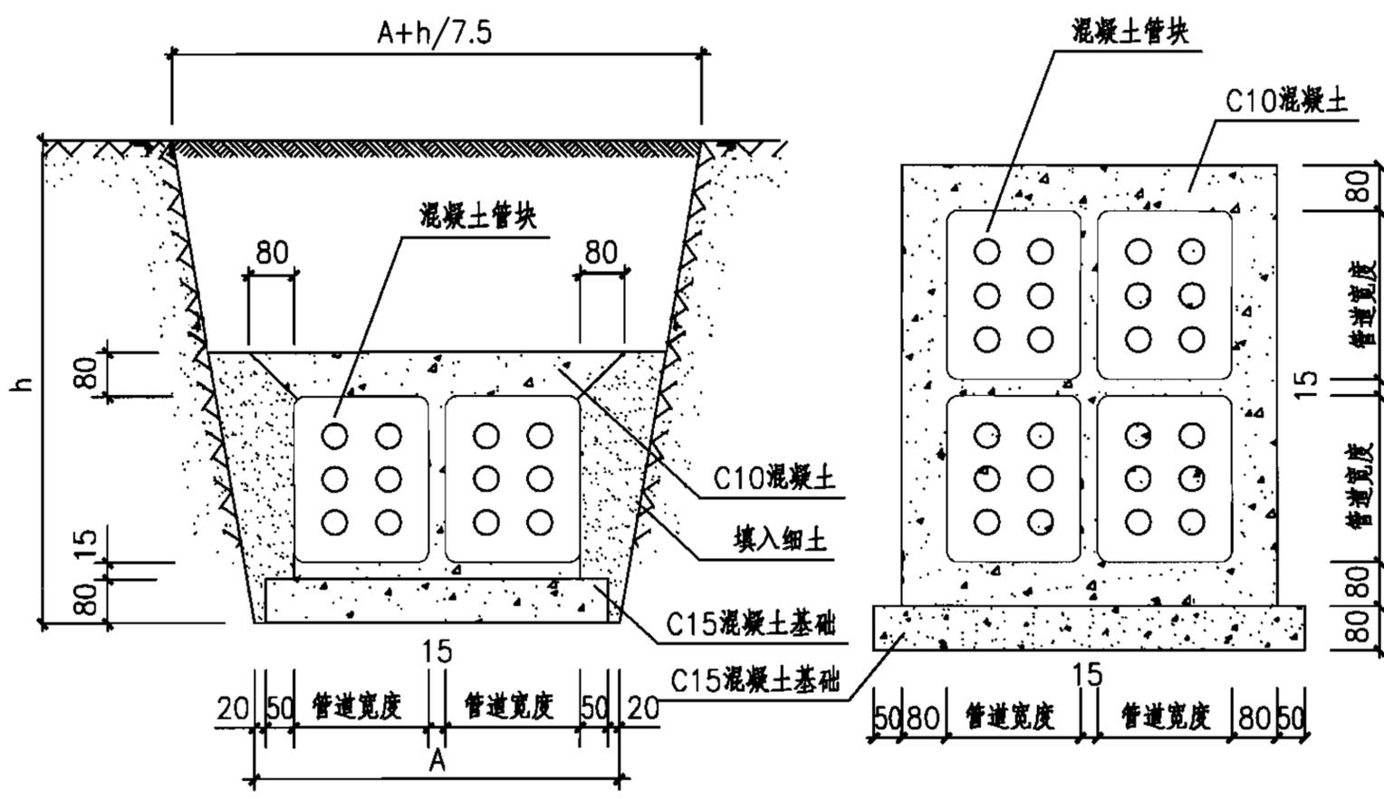
混凝土管块管顶上覆保护示意图
