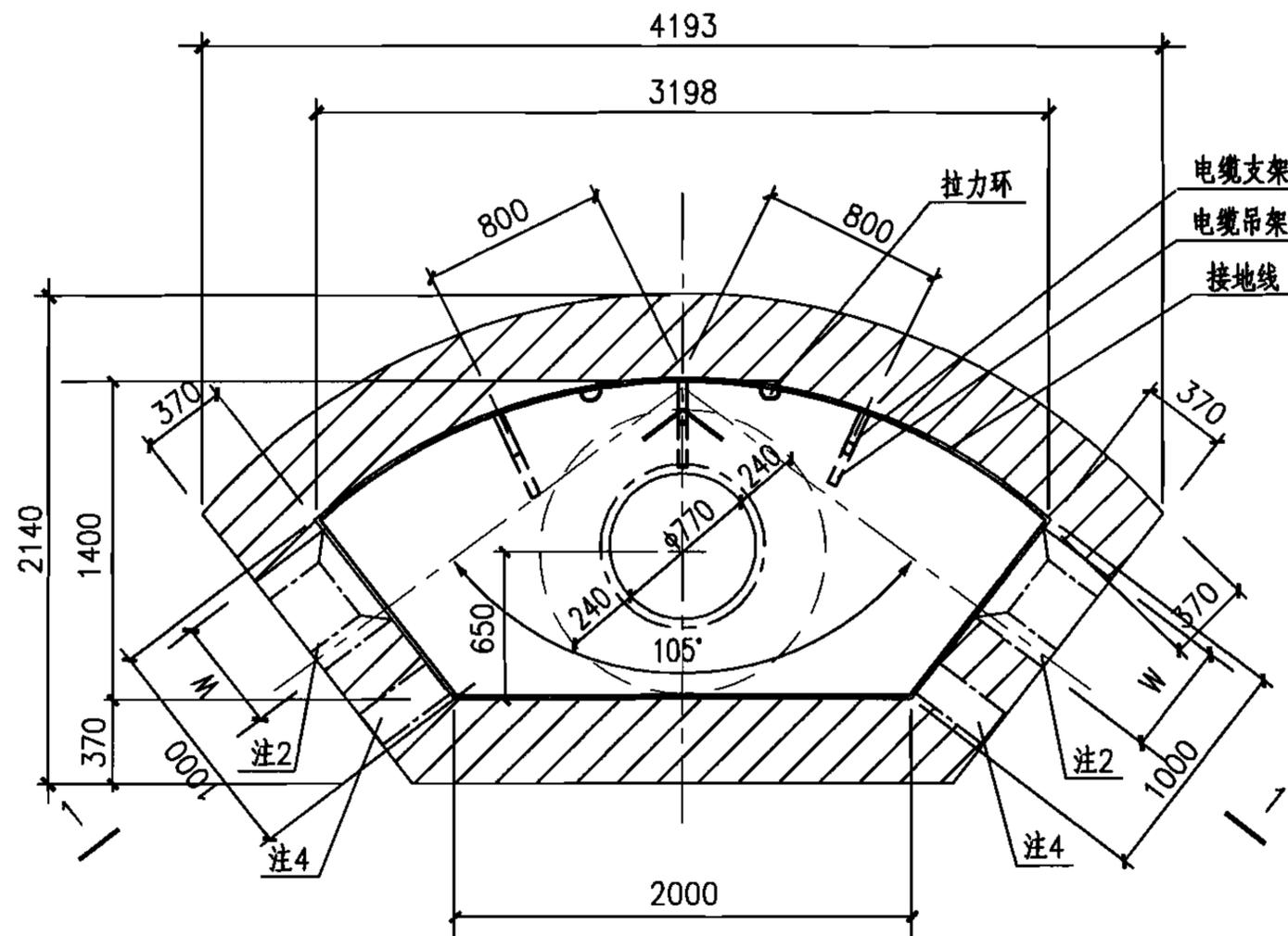
中型105°转角型电缆井平面图
