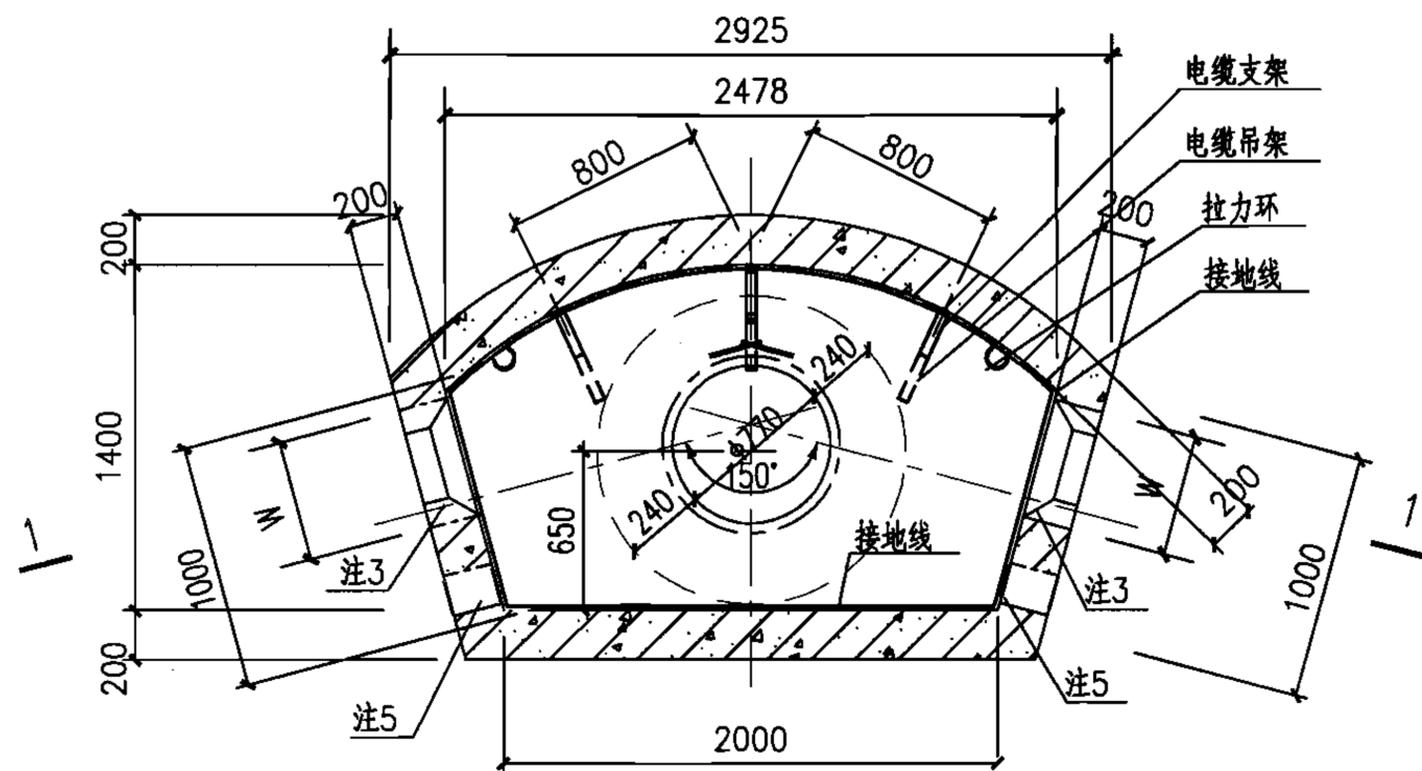
中型150°转角型电缆井平面图
