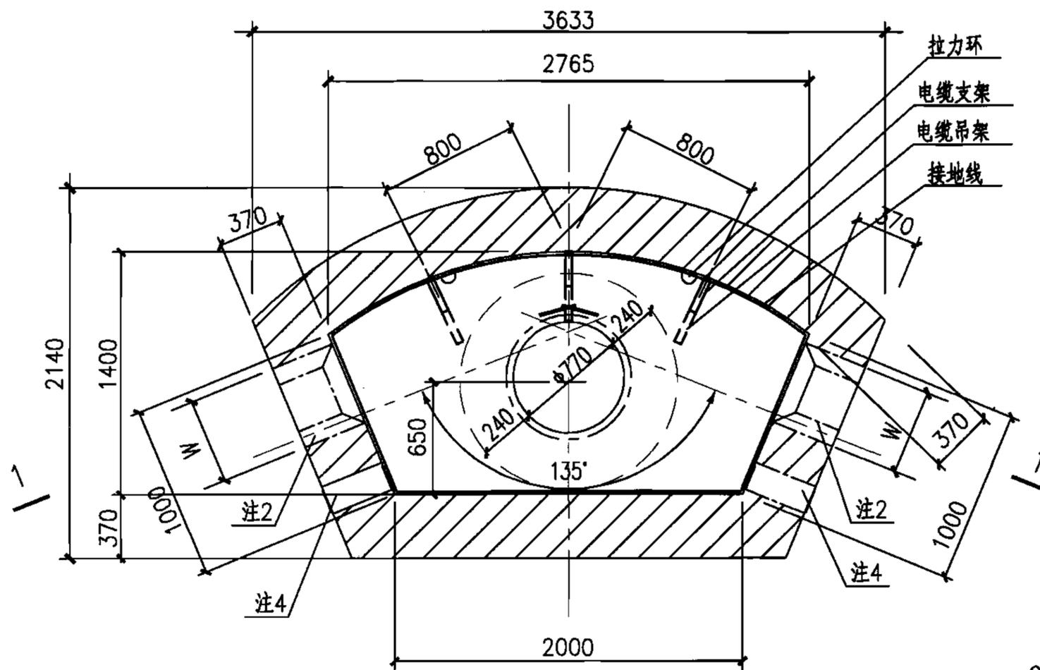
中型135°转角型电缆井平面图
