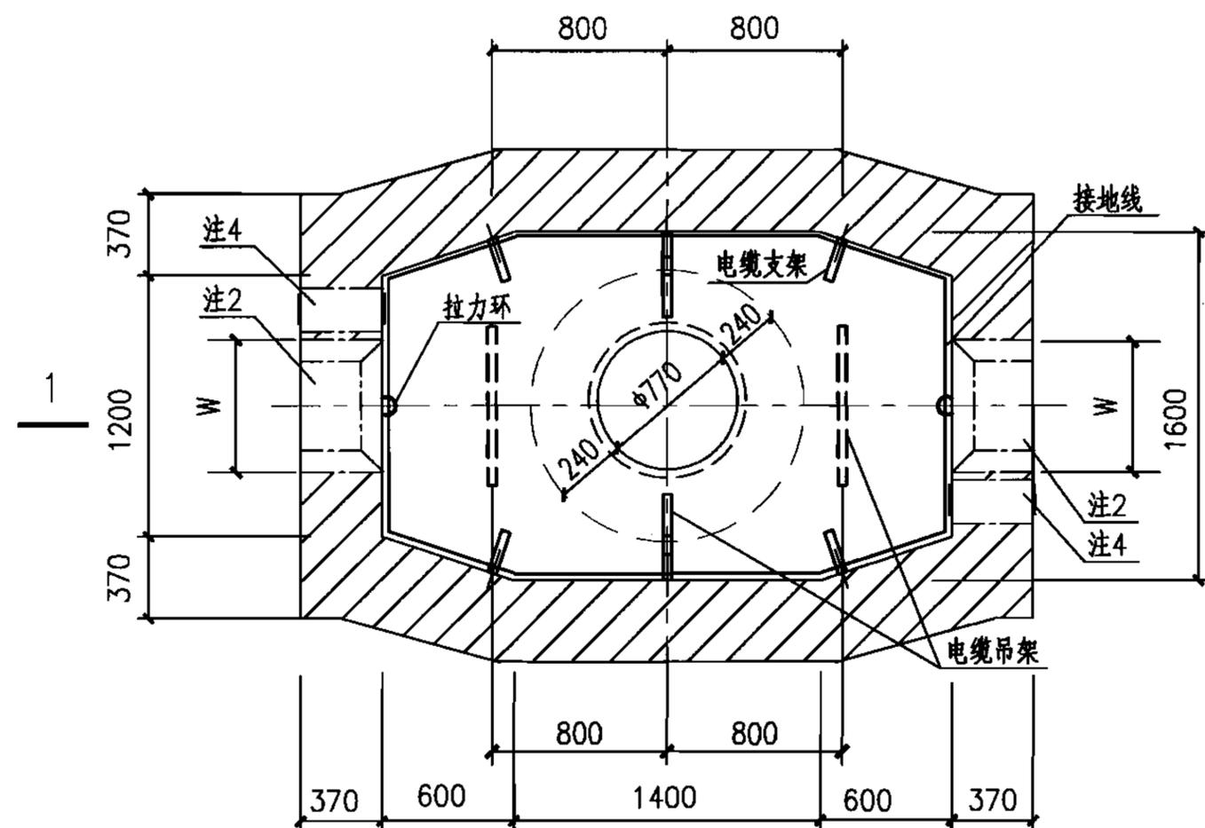
中型直通型电缆井平面图
