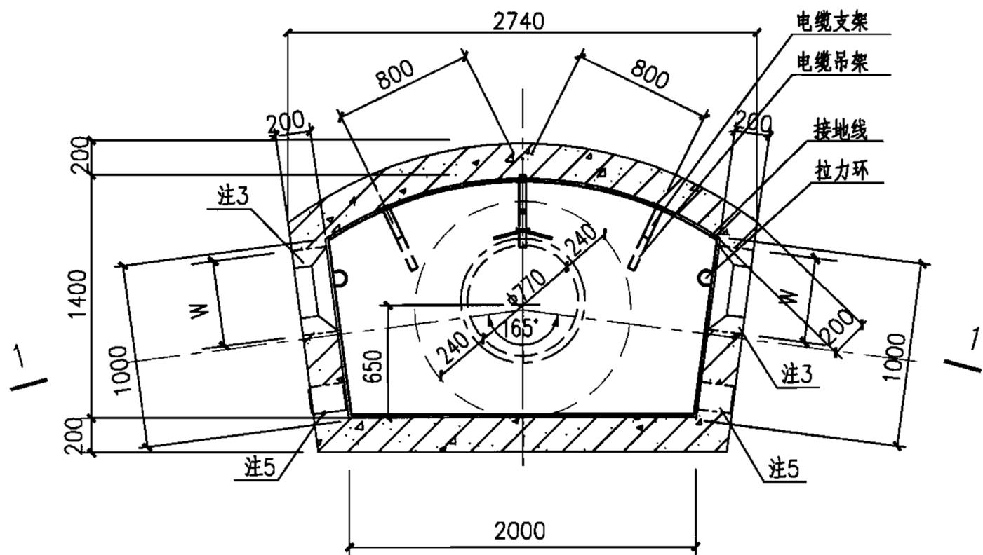
中型165°转角型电缆井平面图
