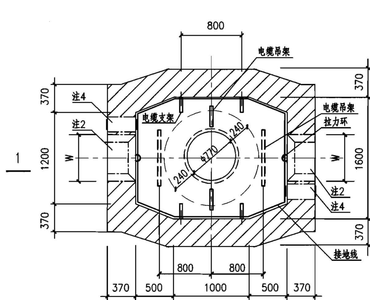
小型直通型电缆井平面图
