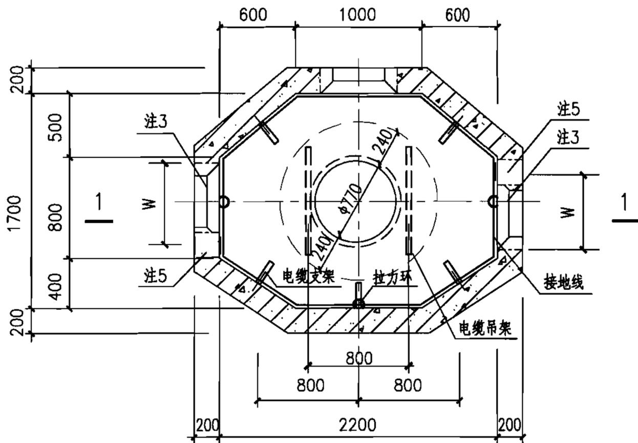
中型三通型电缆井平面图
