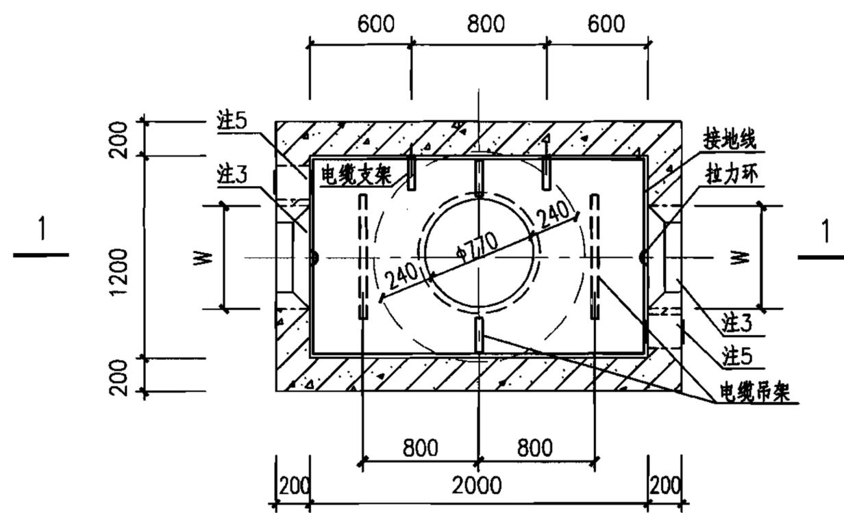
小型直通型电缆井平面图
