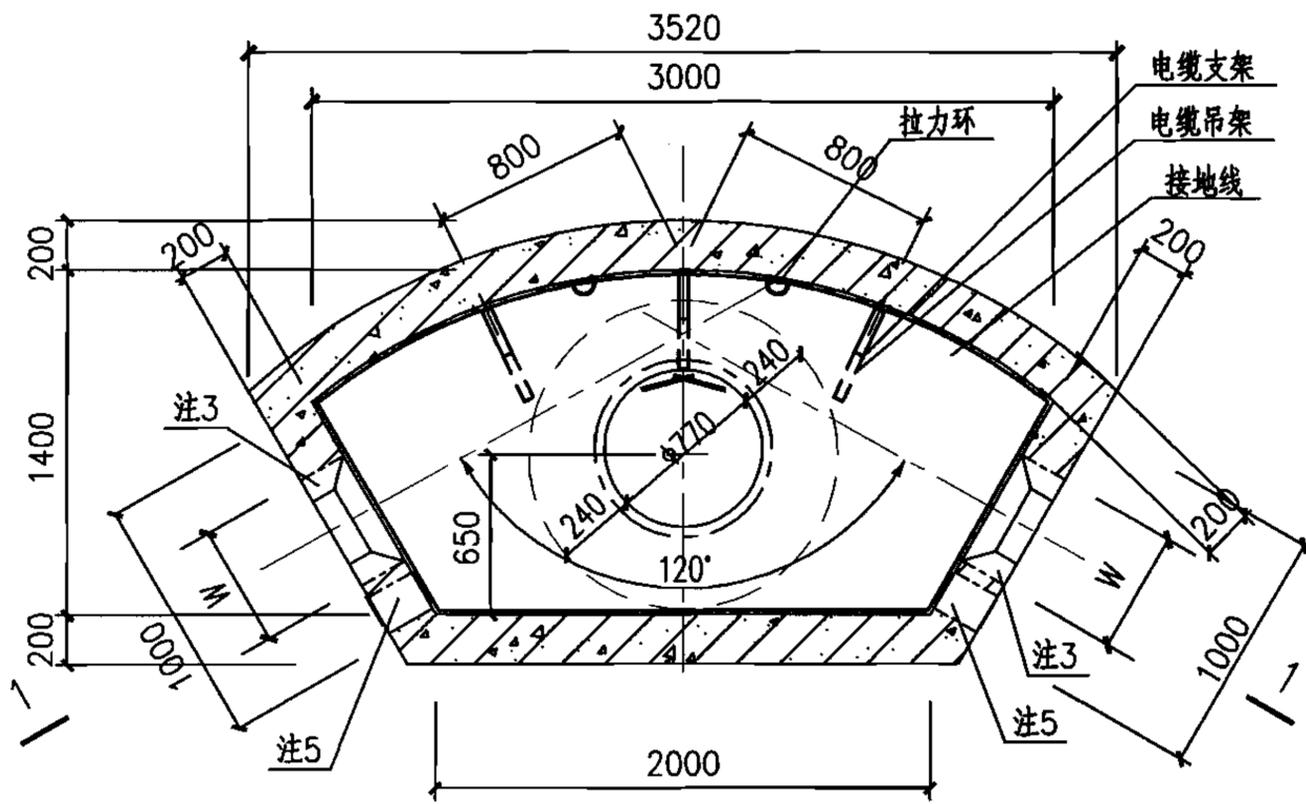
中型120°转角型电缆井平面图
