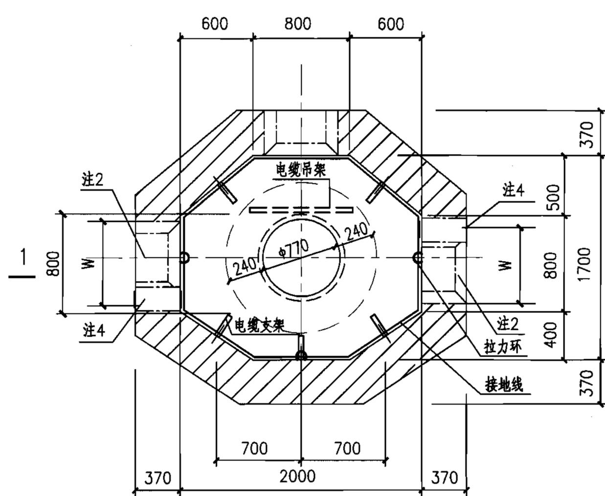
小型三通型电缆井平面图
