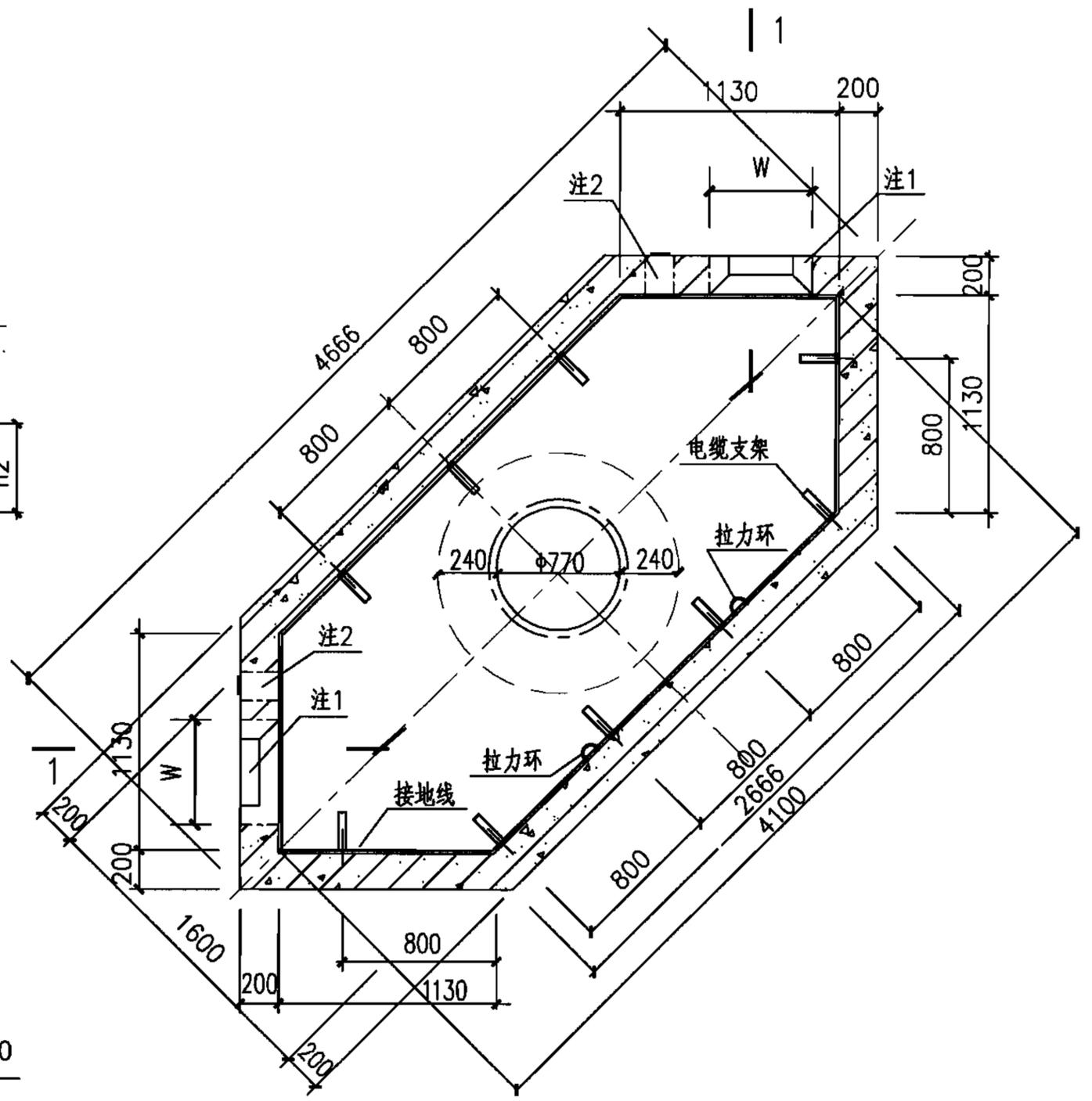
中型90°转角型电缆井平面图
