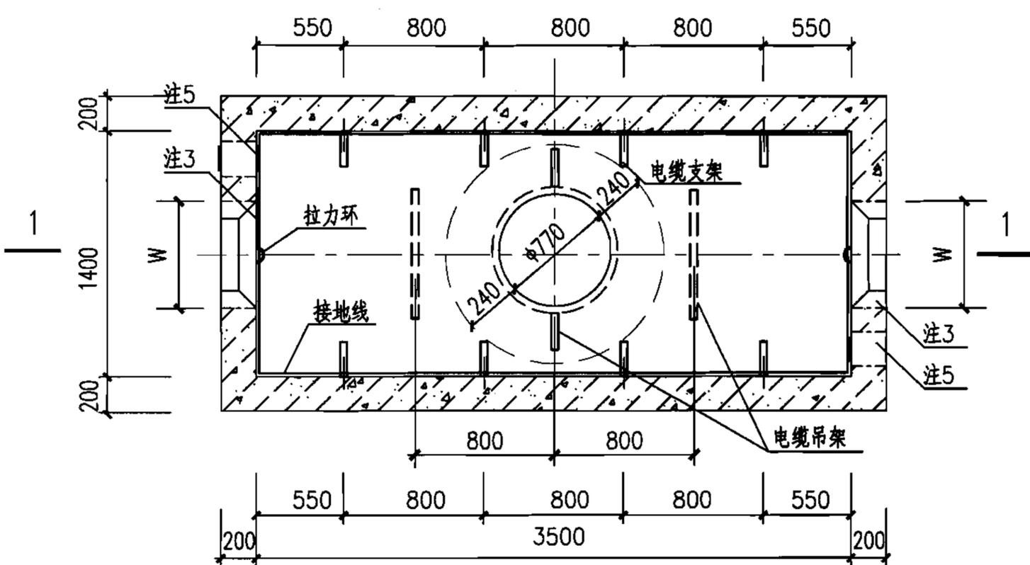
大型(二)直通型电缆井平面图
