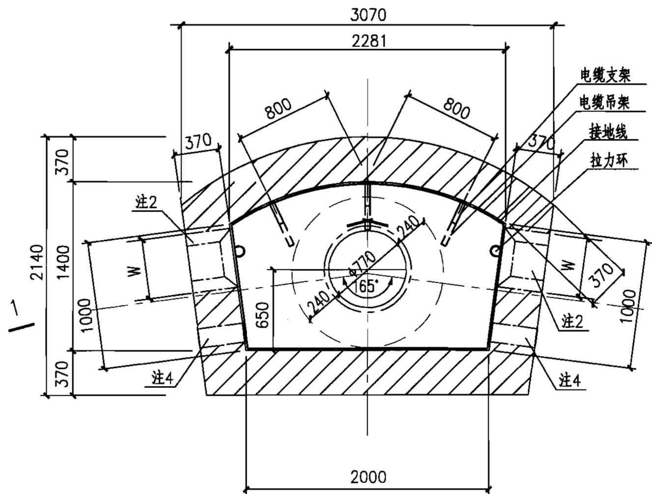
中型165°转角型电缆井平面图
