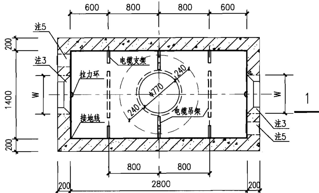
大型(一)直通型电缆井平面图
