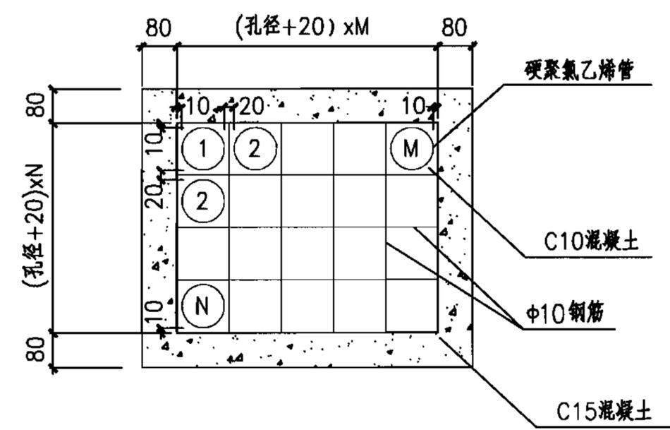
硬聚氯乙烯管道包封保护方法
