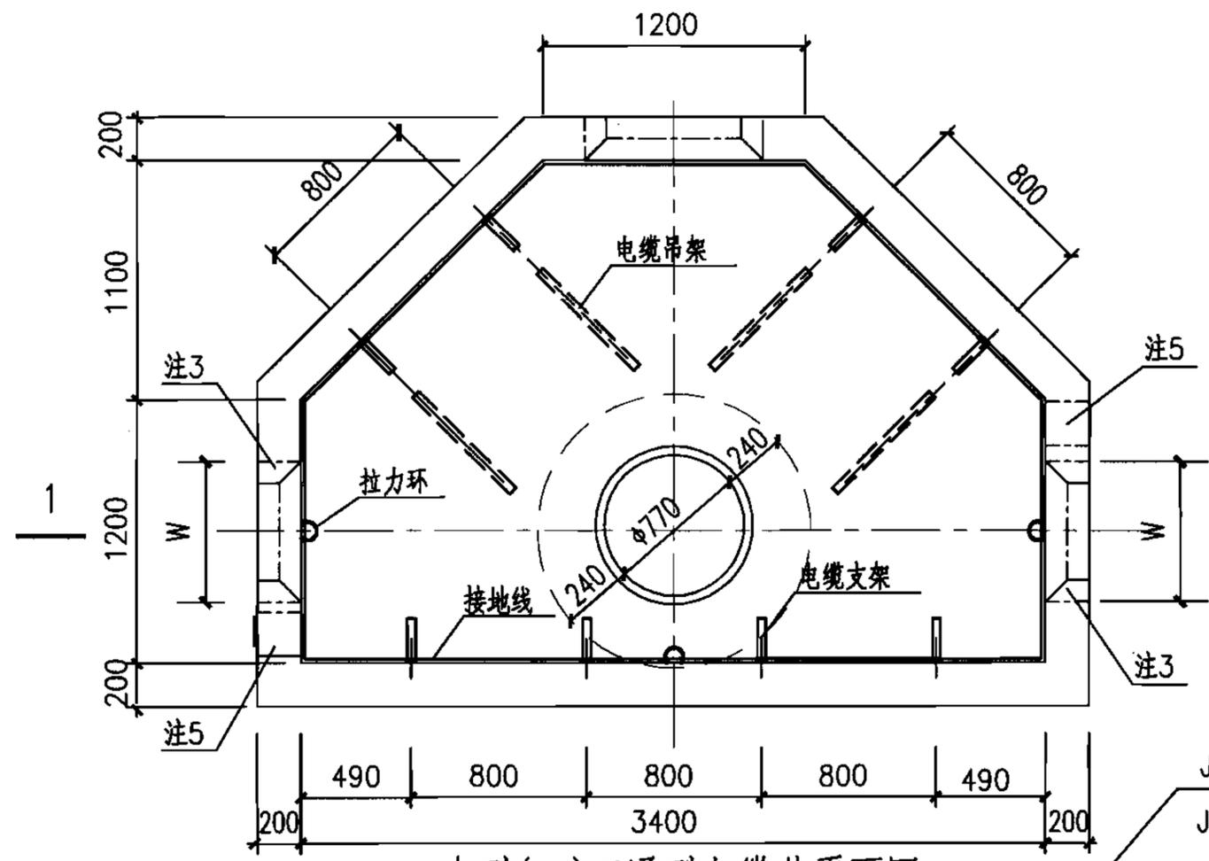
大型(一)三通型电缆井平面图
