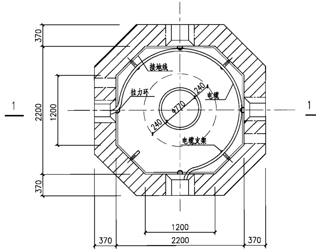
电缆在电缆井中预留平面图
