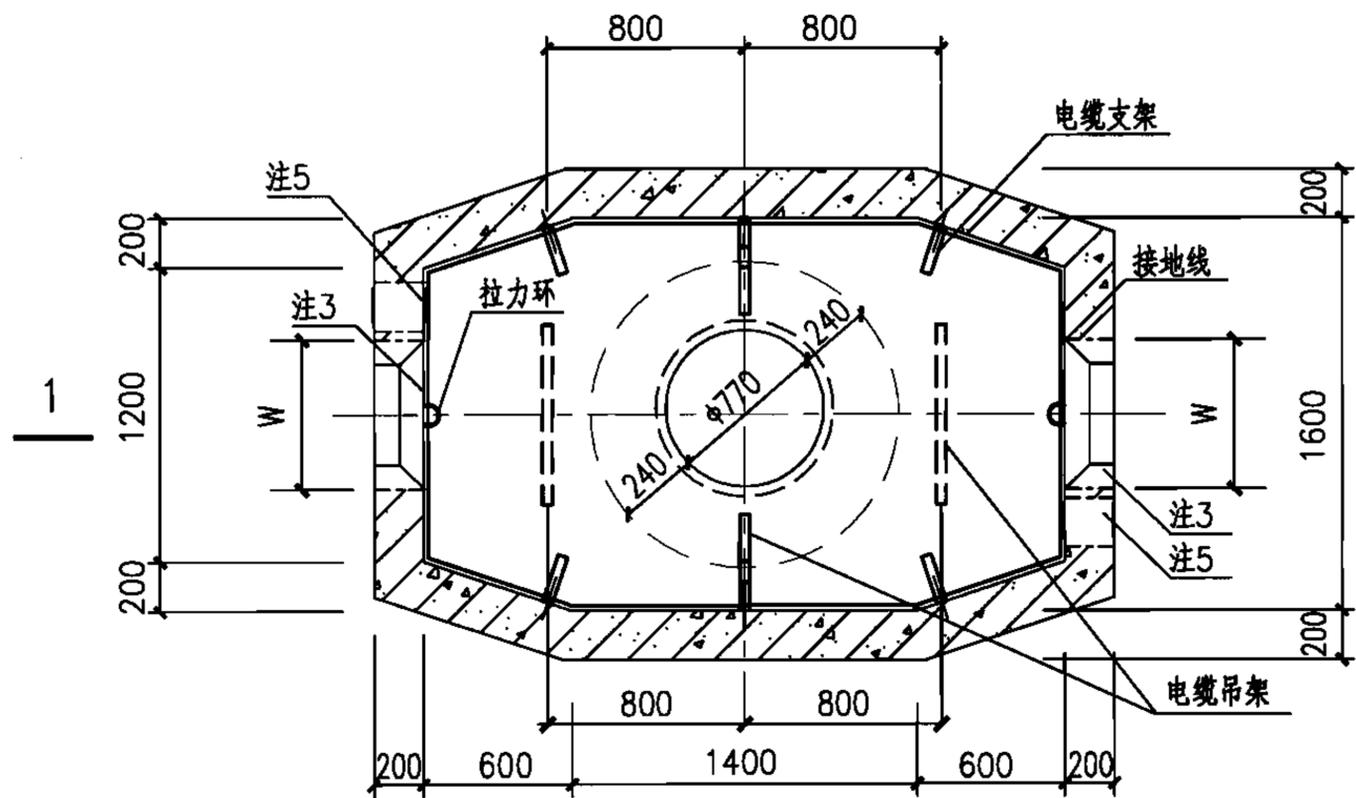
中型直通型电缆井平面图
