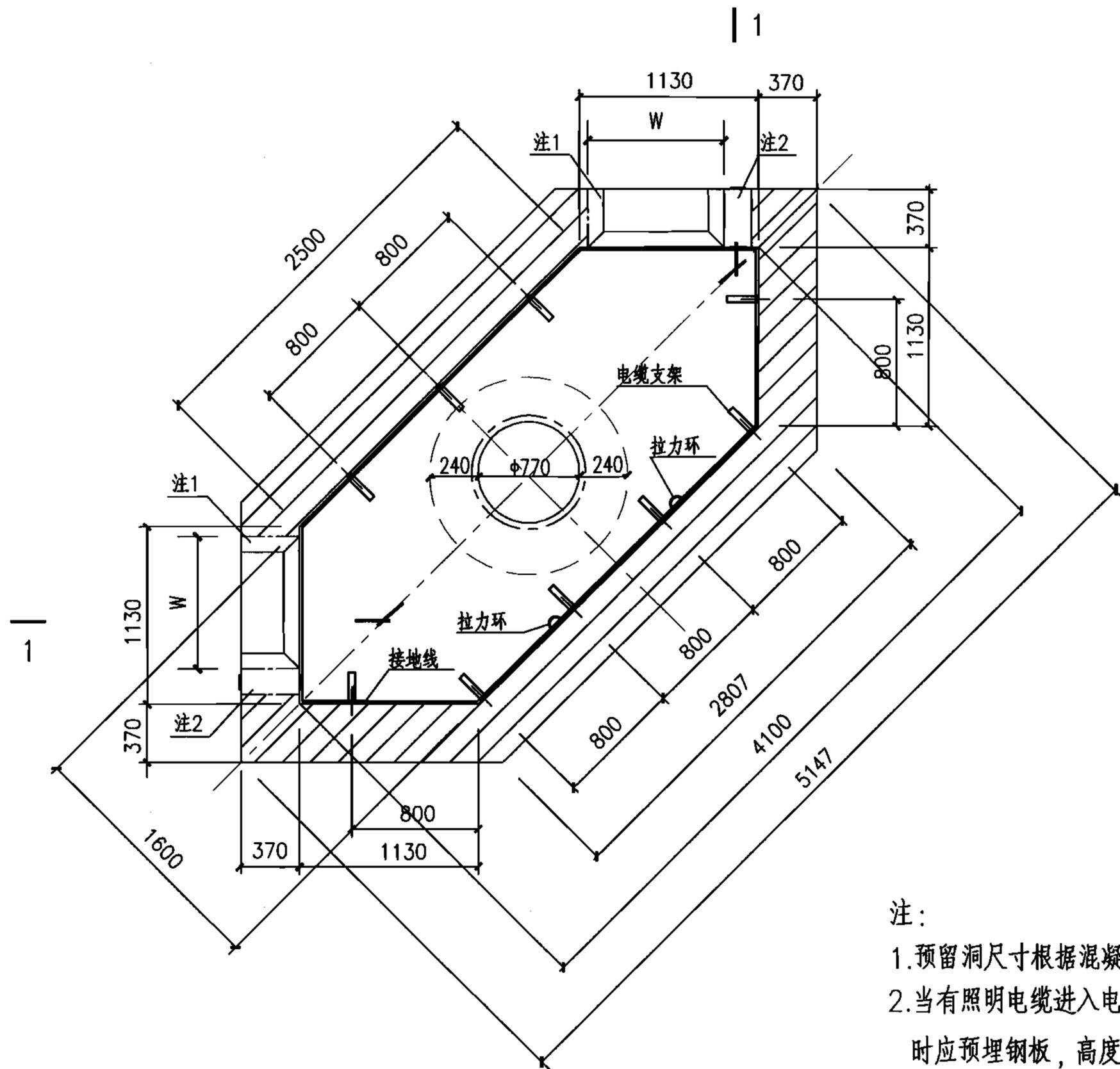
中型90°转角型电缆井平面图
