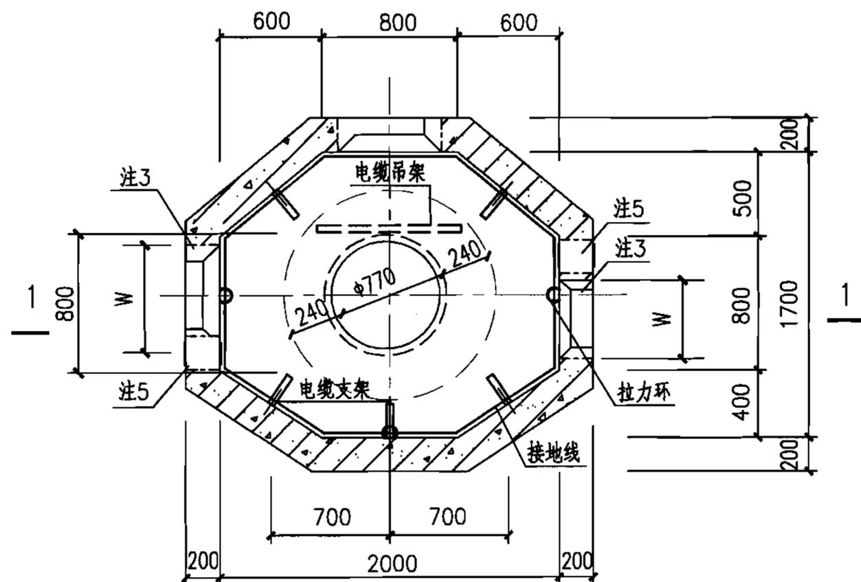
小型三通型电缆井平面图
