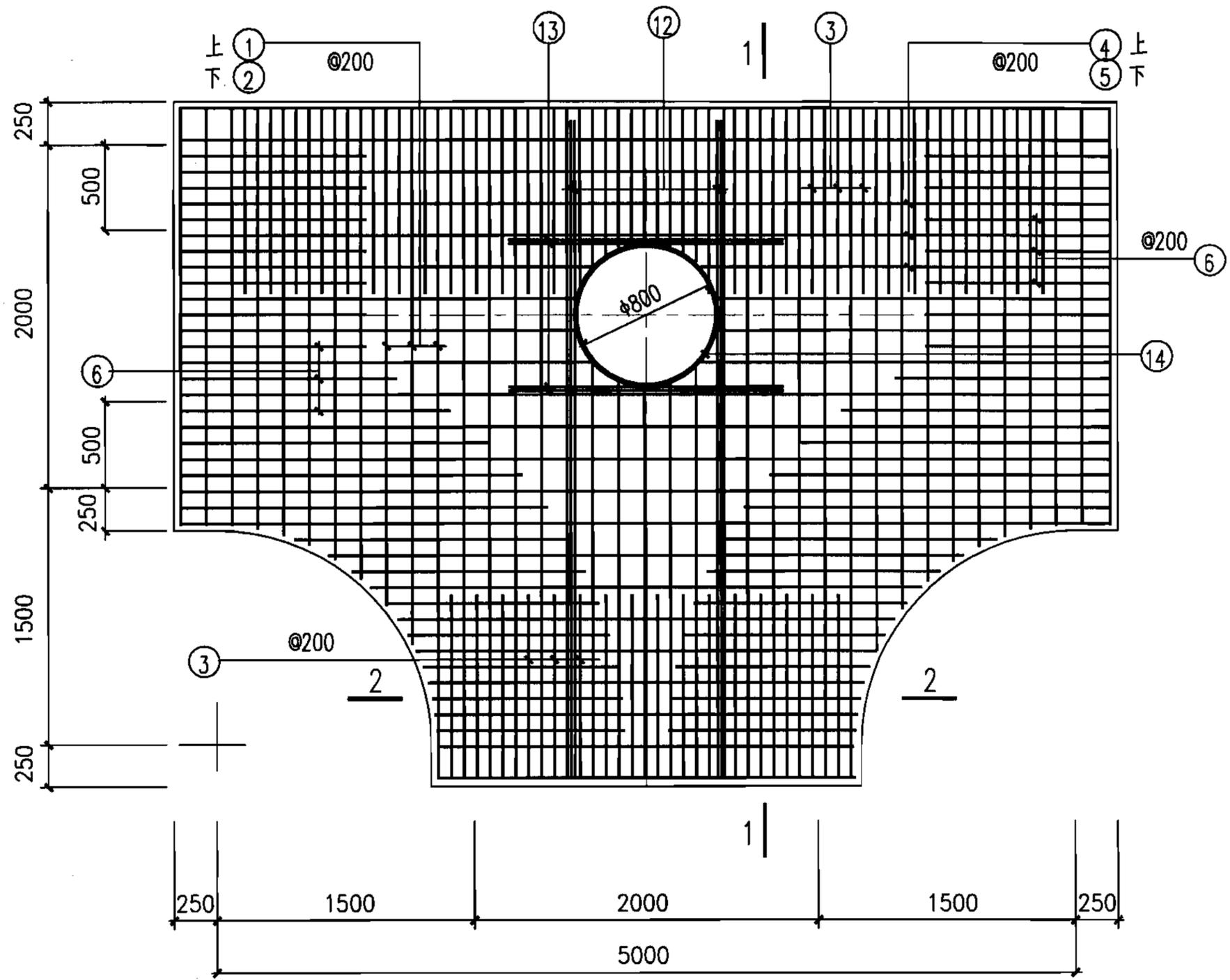
大型(二)三通型电缆井平面图
