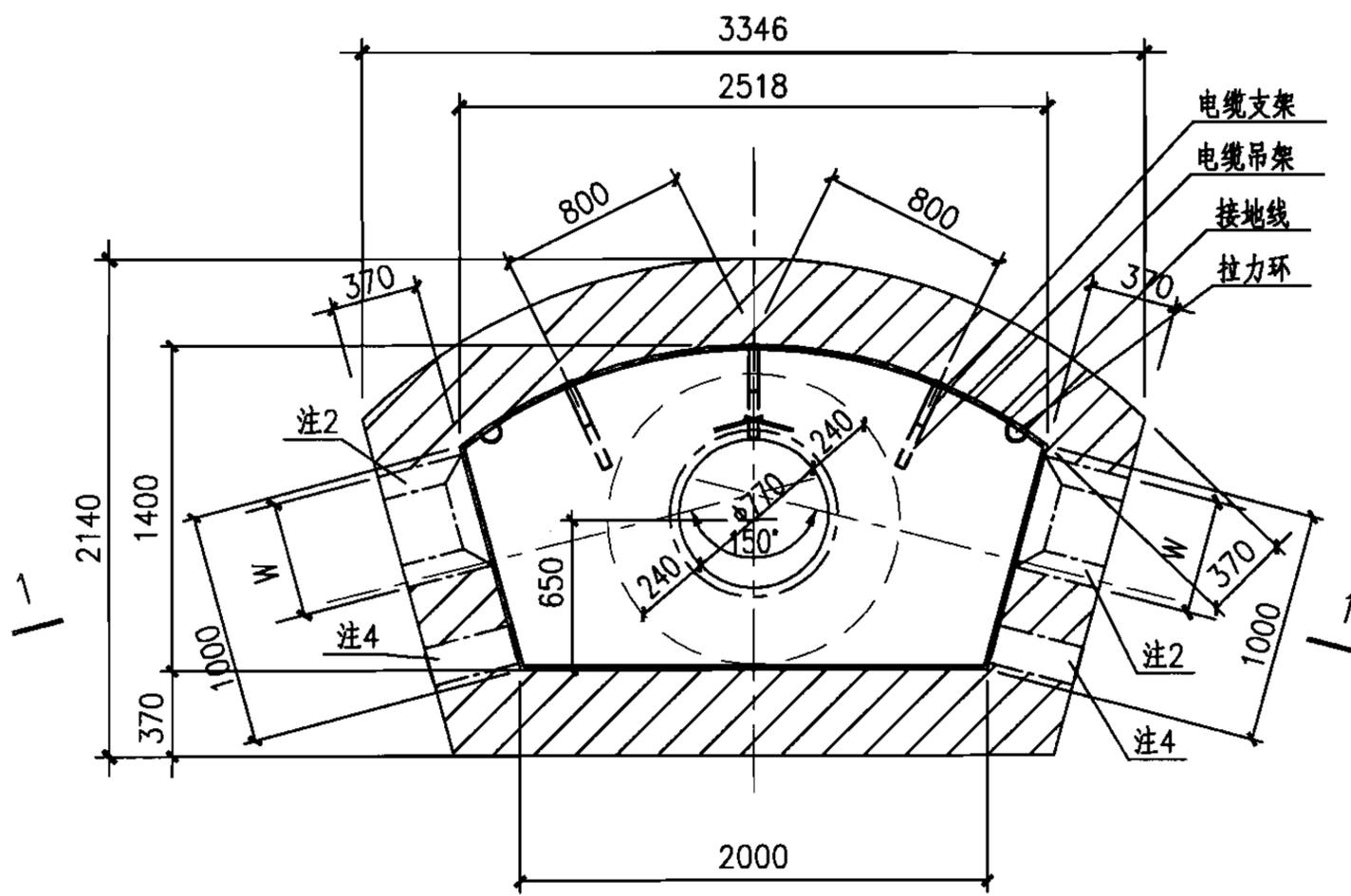
中型150°转角型电缆井平面图
