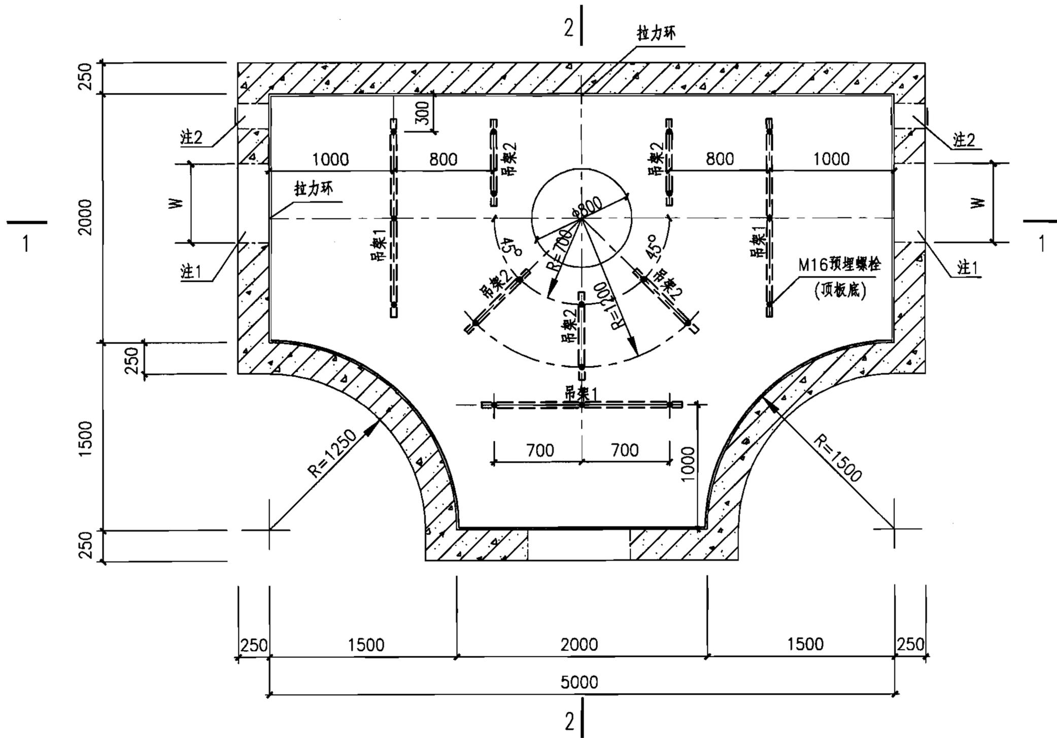
大型(二)三通型电缆井平面图
