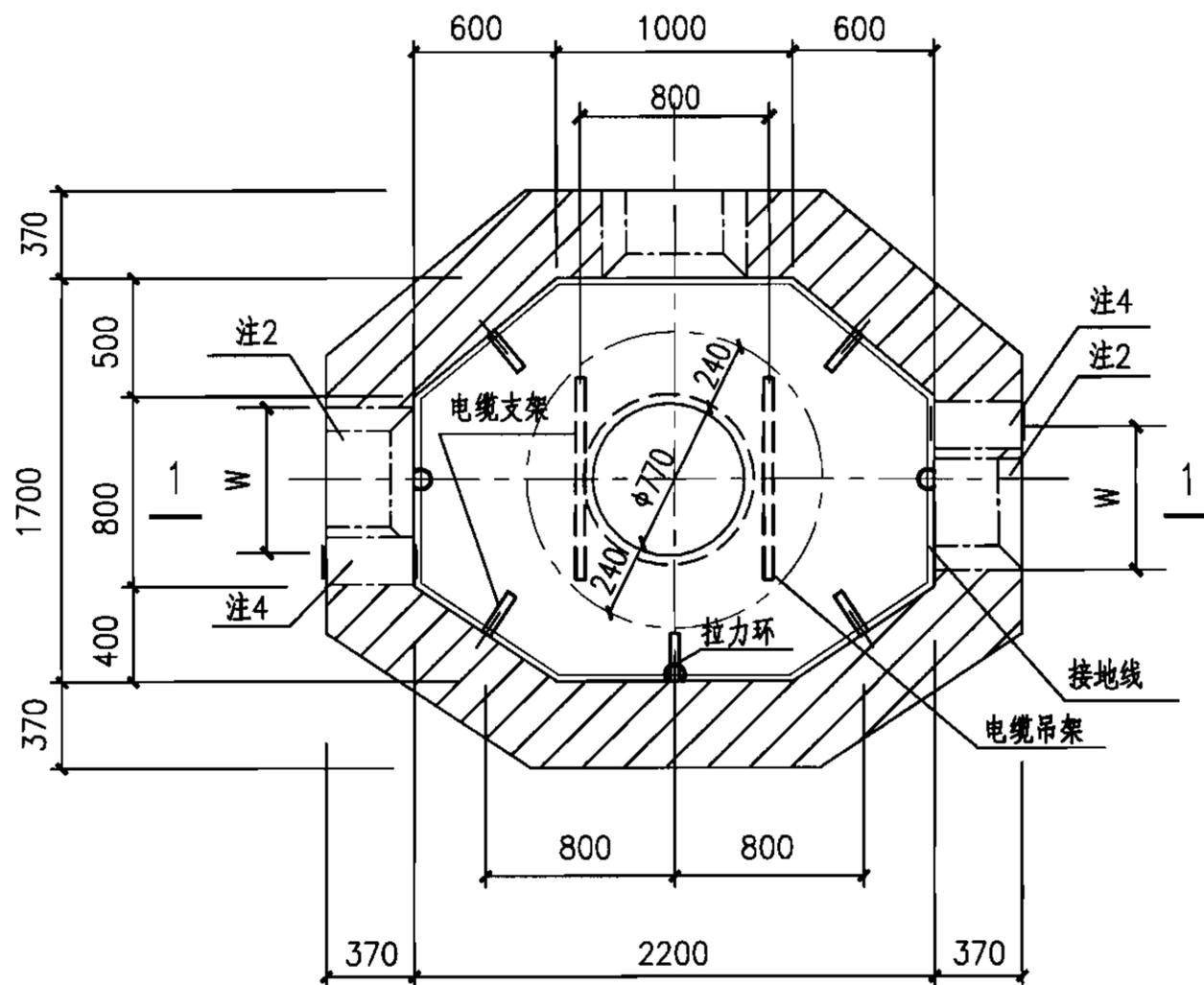
中型三通型电缆井平面图
