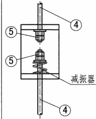
图18(减振装置)
