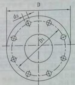
法兰式消火栓法兰连接
