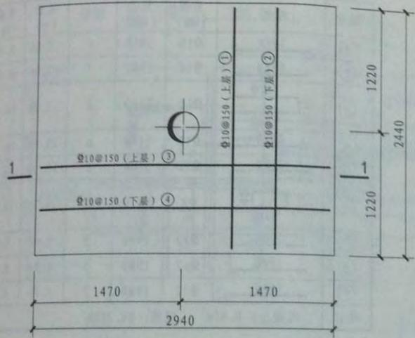
下层底板配筋平面图
