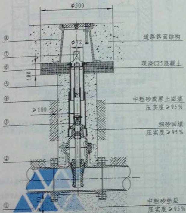
闸阀直埋基础及回填
