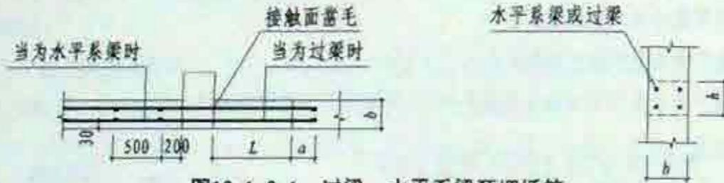
图10.1.2-1 过梁、水平系梁预埋插筋
