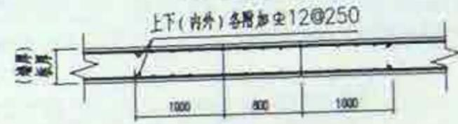
楼板、混凝土墙后浇带
