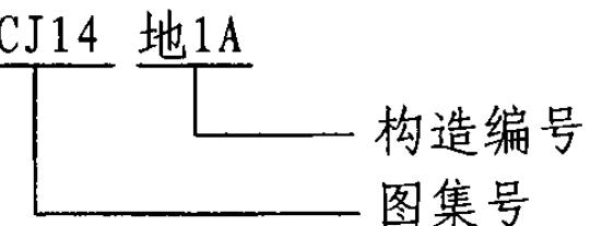
如垫层或楼面填充层厚度与工程设计需要不同时，可在所选构造编号加脚标注明
